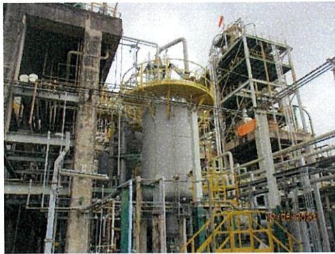
ภาพที่ 2-10 ถึง Waste Catalyst (D110)
